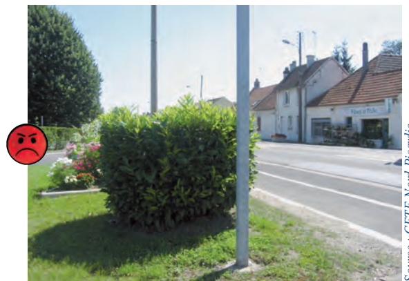
En milieu urbain : exemples d'arbustes gênant la visibilité au niveau d'un STOP.
